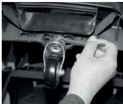
Figura 11 – Reaperto do parafuso do rodízio
