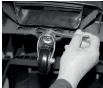
Figura 11 – Reapriete del perno de la rueda
